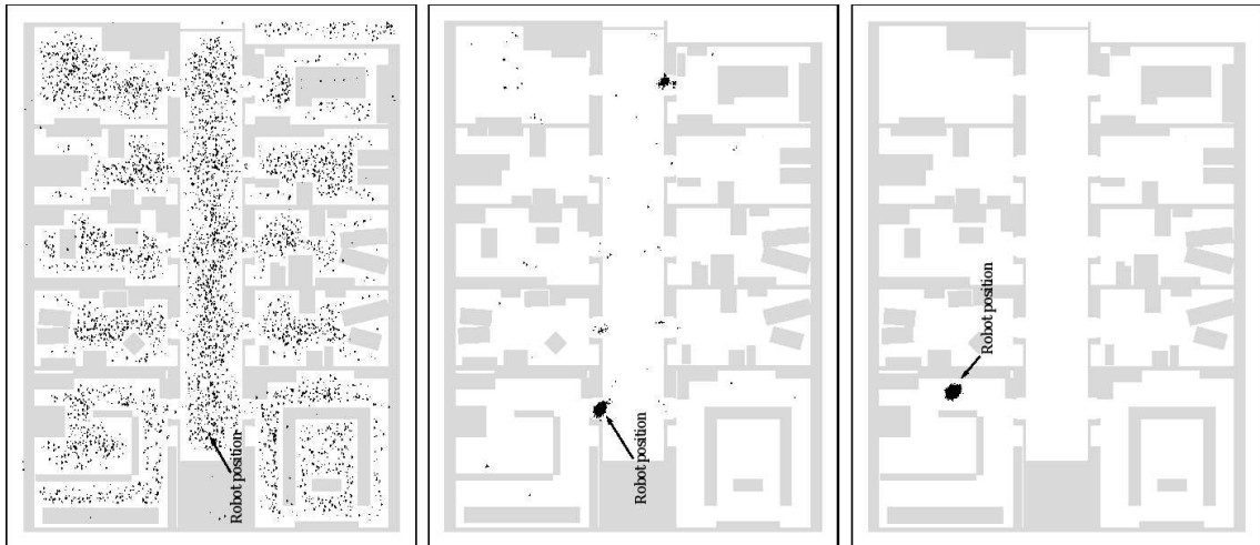
Figura 2.3: Immagine tratta da [1] che mostra la distribuzione di particelle in tre fasi della localizzazione.
