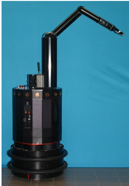
Figura 1.1: La base mobile Nomad 200 e il manipolatore Manus .
