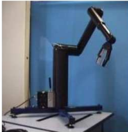
Figura 1.1: Robot Manus con input device (joystick, keypad), box per invio dei comandi, e LED matrix display per visualizzare lo stato
