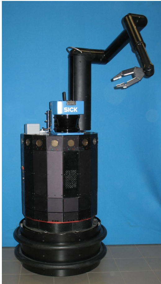
Figura 3.1: Il robot mobile Nomad 200.
