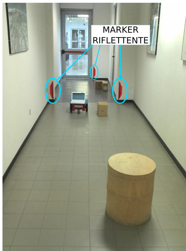
Figura 5.1: Ambiente in cui è stato eseguito uno dei test: si notano i tre landmark riflettenti e alcuni ostacoli statici.
