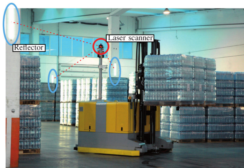
Figura 4.1: Fotografia di un impianto industriale in cui si notano un LGV e tre marker riflettenti (immagine tratta da [41]).
