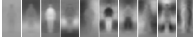
Figura 2.3: Esempio dei primi 10 autovettori 24 \times 48 estratti dal dataset di pedoni Daimler-DB
