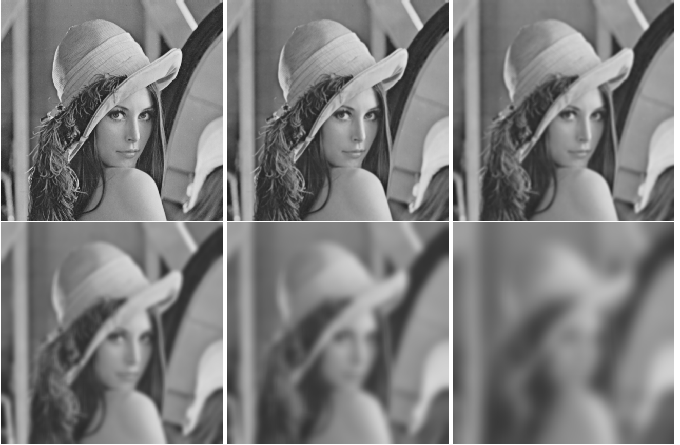
Figura 5.2: Rappresentazione scala-spazio di una immagine 512 \times 512 : dall'immagine originale t = 0 alle scale 1, 4, 16, 64 e 256.
