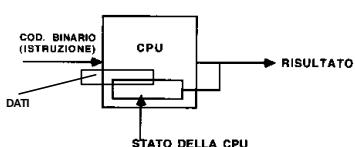
A livello schematico, la combinazione di istruzione, dati e stato della CPU determina il risultato.
