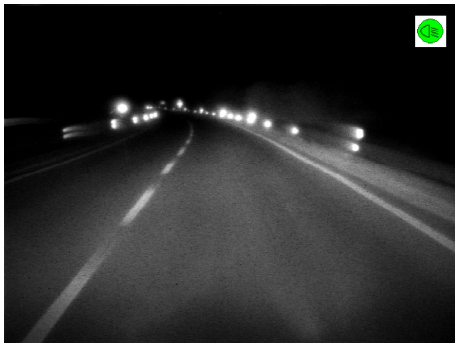
Figura 6.20: Riconoscimento di un veicolo notevolmente distante.
