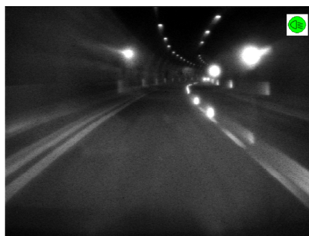
Figura 6.15: Caso di falso positivo: l'algoritmo riconosce come veicoli degli insoliti fari lampeggianti presenti in galleria.
