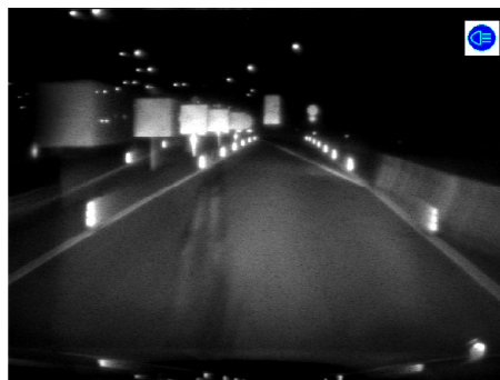
Figura 6.5: L'algoritmo decide correttamente di non spegnere i fari abbaglianti nonostante sia presente molto rumore.
