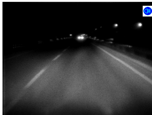
Figura 7.1: Limite del programma: elaborando nella modalità con abbaglianti accesi non riconosce un veicolo che precede se distante meno di 50 metri.
