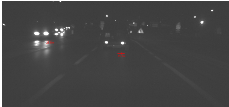
Figura 7.3: Il radar funziona efficacemente anche con più veicoli inquadrati.
