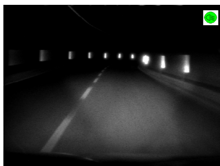
Figura 6.3: Esempio di falso positivo. L'algoritmo comanda lo spegnimento degli abbaglianti (vedi icona) nonostante non sia presente nessun veicolo.
