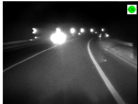
Figura 6.21: Corretto riconoscimento di un veicolo in curva.
