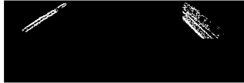
Figura 3.11: Contorni delle linee della carreggiata dopo l'erosione.
