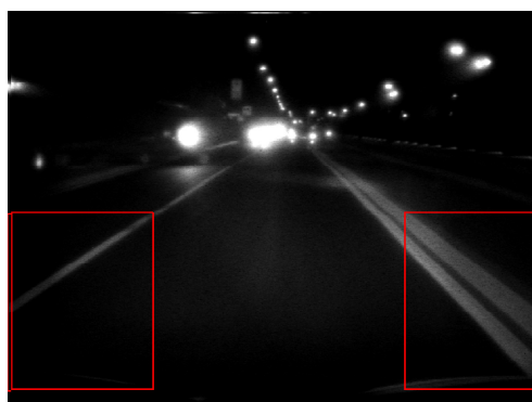
Figura 3.9: Porzione d'immagine sulla quale viene applicata la trasformata di Hough.
