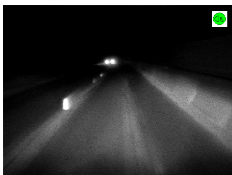
Figura 6.16: Corretta rilevazione di un veicolo a distanza considerevole.
