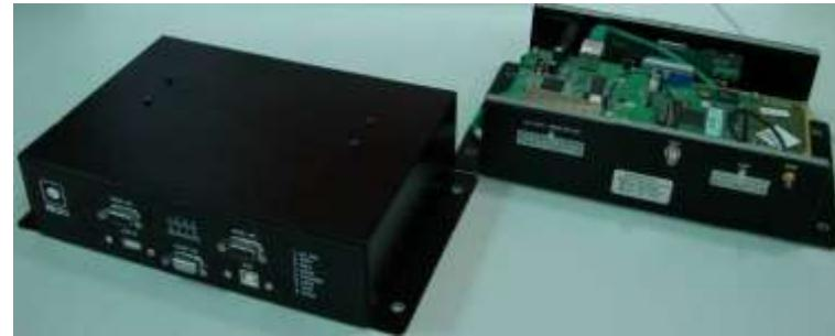
**Un laser scanner, sviluppato nell'ambito del progetto, con l'obiettivo di realizzare un'apparecchiatura a basso costo, accessibile al mercato automotive.**
