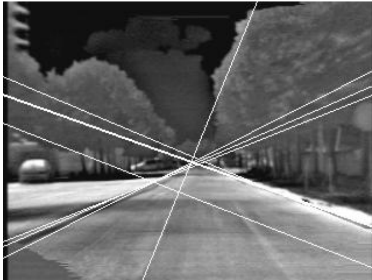
Figura 2.5: Linee trovate dai metodi di Hough
