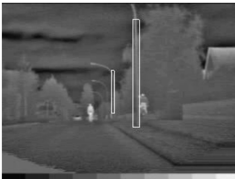
Figura 3.9: Sequenza di pali correttamente riconosciuta
